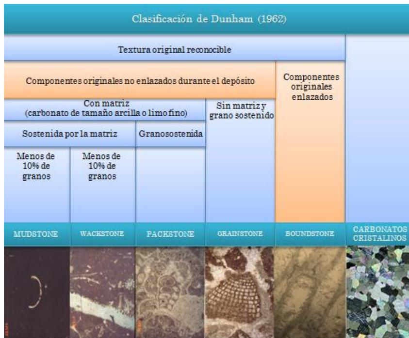
Clasificación Textural de rocas carbonatadas según Dunham (1962). Imagen tomada de la red
