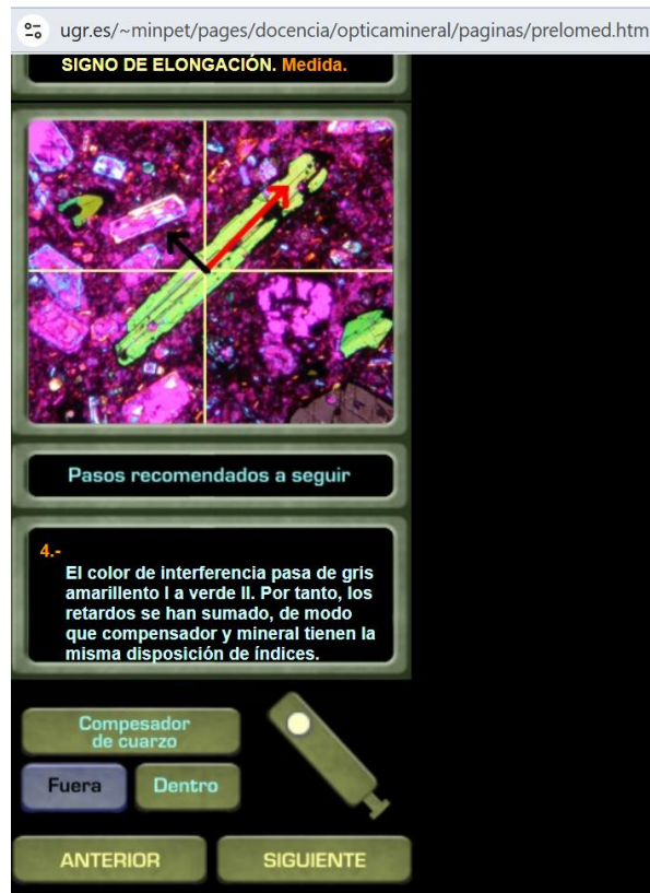
Pasos 3 y 4 para determinar el signo de elongación
