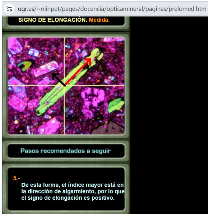
Pasos 3 y 4 para determinar el signo de elongación
